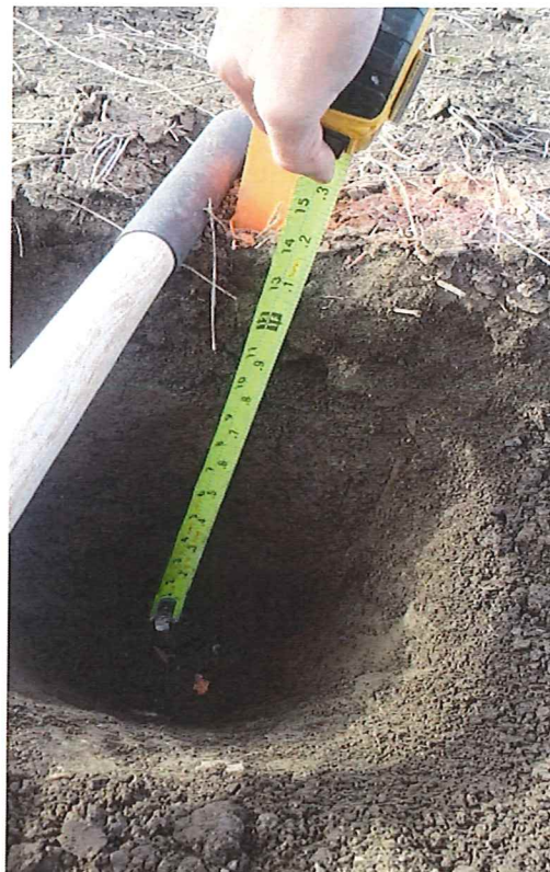
P34 - STA 62+50 Existing Topsoil
